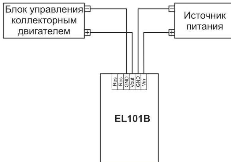
Рисунок 3 – Схемы подключения модуля защиты
